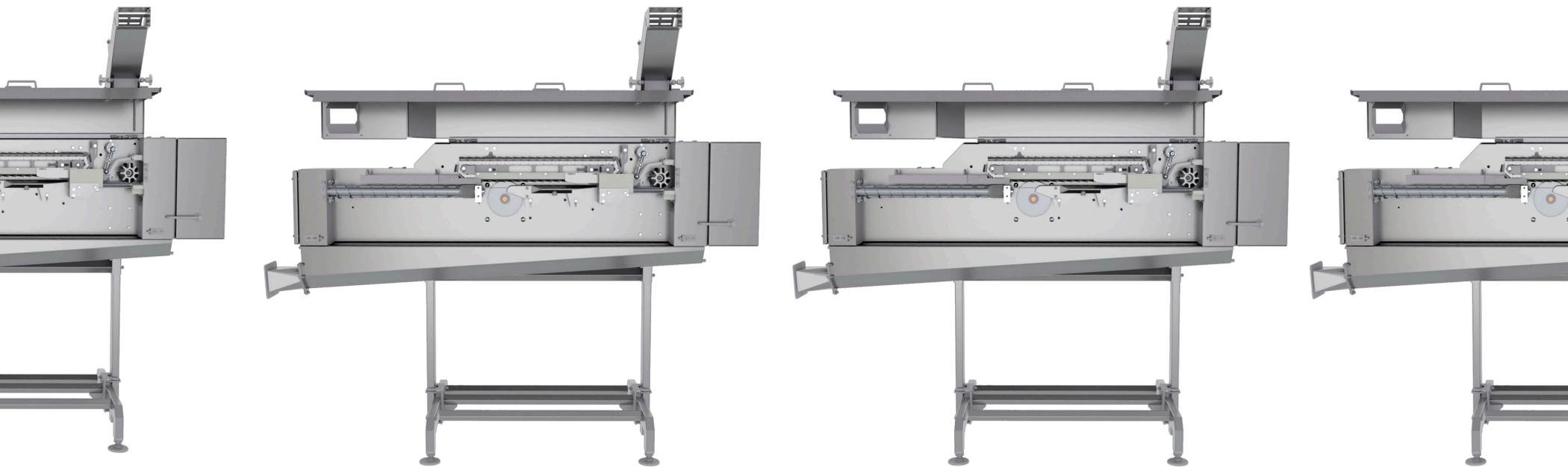
Оборудование полностью выполнено из разрешенных для пищевой промышленности материалов, преимущественно из нержавеющей стали. Леонович-6000 предназначен для установки в линию потрошения после машин первичной обработки. Конечный продукт - тщательно очищенные желудки, готовые к дальнейшей переработке или фасовке. При необходимости возможна дополнительная ручная доочистка на контрольном столе.
